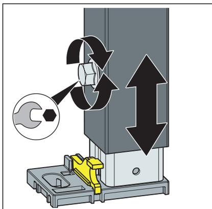
➤ Die Füße des Elements mit einem Mautschlüssel lösen.
