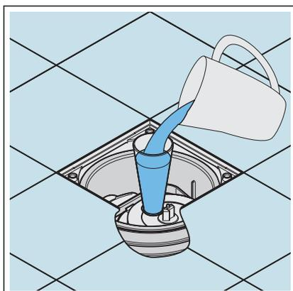
► Die Prüfvorrichtung bis zur oberen Markierung mit Wasser befüllen.
