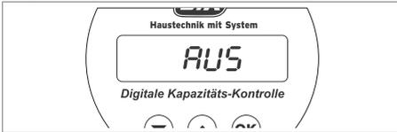
Bei aktivierter Leitwertüberwachung können Sie Grenzwert von 10 - 200  $\mu\text{S}$  einstellen.
