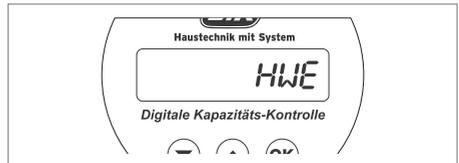
Wählen Sie mit der **↓**- oder **↑**-Taste die Größe der Kartusche (2,5, 4, 7, 14 oder 30 Liter) und speichern Sie mit der **OK**-Taste.
