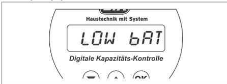
Um die Batterie zu tauschen, schrauben Sie den Deckel ab und ersetzen Sie die Batterie (CR-2032). **Achten Sie auf die richtige Polarität!**
