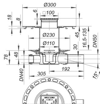
Komplettablauf bestehend aus Bodenablaufgehäuse 42 S, TistoDrain Aufstockelement S 10 und einem stufenlos bis zu 40 mm höhen- und bis zu +/- 5,5 mm seitenverstellbaren Aufsatz.
