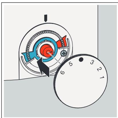
**HINWEIS!** Setzen Sie den Drehknopf erst auf den Raumthermostaten, wenn das Gehäuseoberteil montiert ist.
